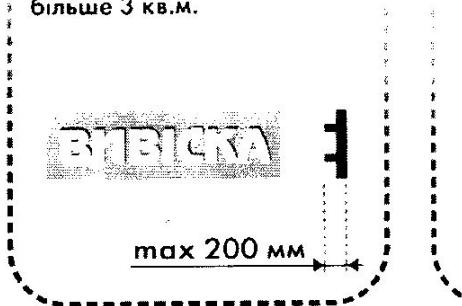
**Плоский прапор, вимпел або кронштейн (площею не більше 1кв.м). Нижня точка конструкції повинна бути на 2,5 м над землею. Виступ не більше 800 мм.**
